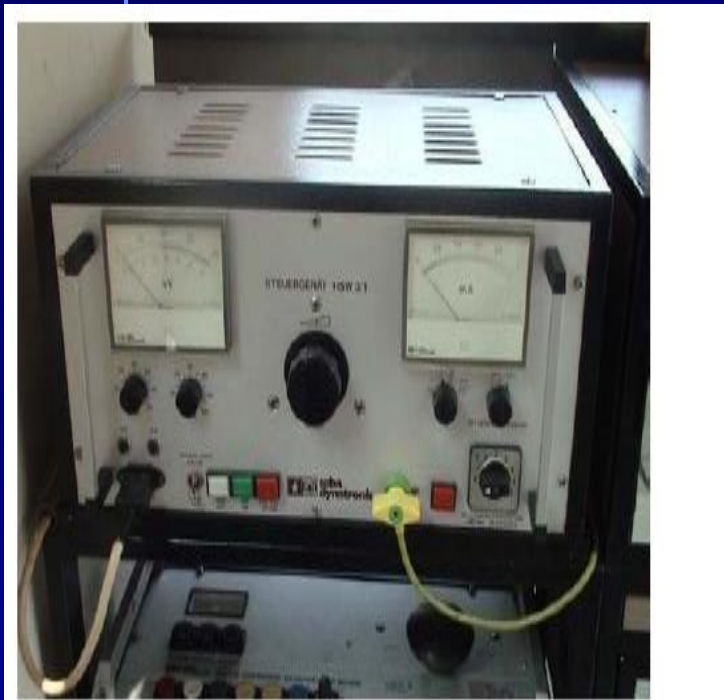
Tester Tegangan Tinggi Arus Searah Tester 20 kV Untuk memeriksa adanya tegangan pada kabel masuk / keluar kubikel
